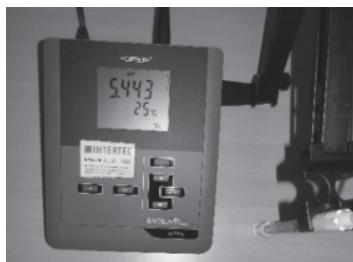
Obr. 2: Plošná elektróda SenTix Sur a pH-meter inoLab.
