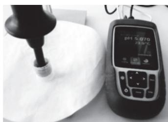
Obr. 3: Vpichová elektróda LanceFET+H a pH-meter SI 600.
