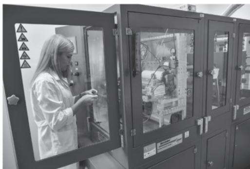
**Obr. 4:** Materiálová tiskárna Coatema Smart Coater.
