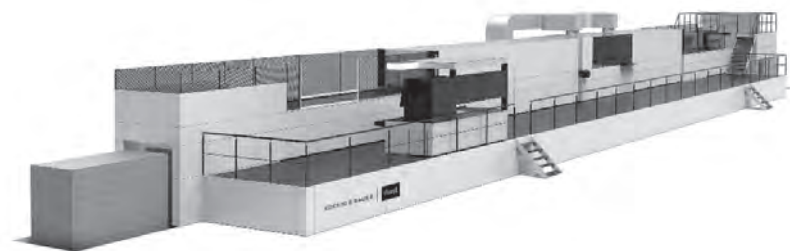
Inkjetový single-pass Delta SPC 130 pro potisk vlnité lepenky
