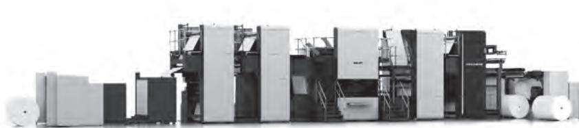
Kotoučový stroj RotaJET v konfiguraci pro tisk obalů
